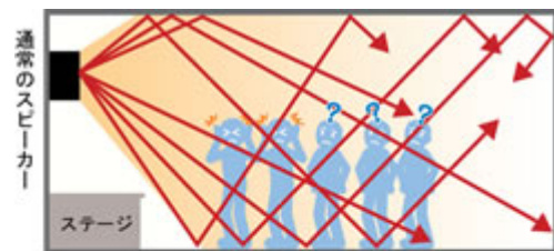
従来のスピーカーでは水平・垂直方向に音が広がり、反射がおきやすい。
