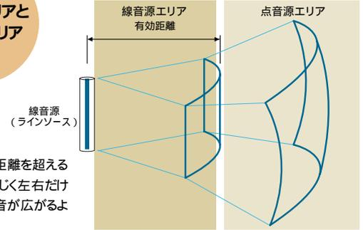
線音源は有効距離を超えると、点音源と同じく左右だけでなく上下にも音が広がるようになります。
