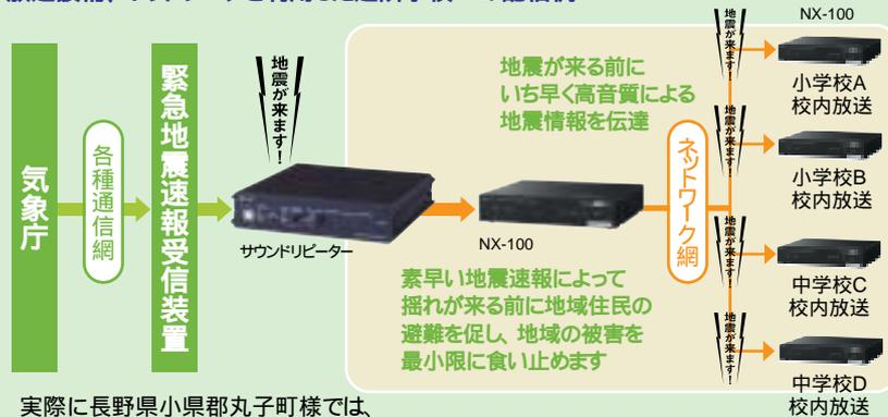
実際に長野県小県郡丸子町様では、NX-100を使用した「地震防災情報システム」を運用されています。
